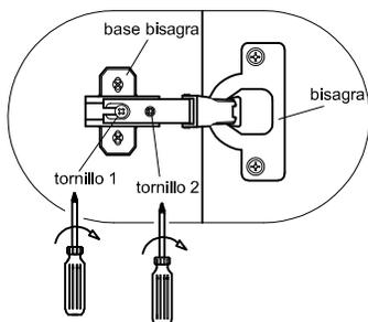
Regule y ajuste la posición de las puertas, aflojando y apretando el tornillo 2, como se muestra en las figuras.
